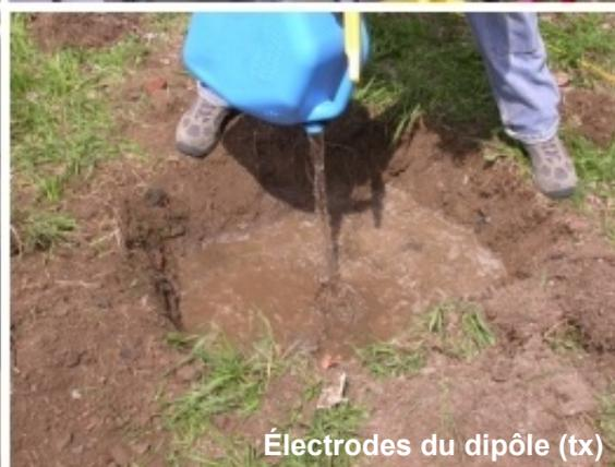
Le CSAMT est une méthode audiomagnétotellurique à source contrôlée par un émetteur dipolaire kilométrique de très haute puissance.
