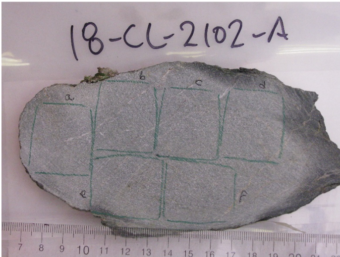
Figure 3. Exemple de tranche de roche avec les cibles numérotées de 'a' à 'f', servant à positionner l'appareil pXRF pendant les mesures. Cette tranche était en train de finir de sécher quand la photo a été prise, mais les mesures ont été faites à sec. La règle servant d'échelle est graduée en cm et en mm.
