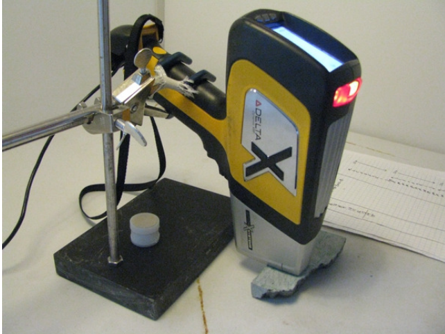
Figure 2. L'analyseur pXRF en action, Baie Déception, août 2018.
