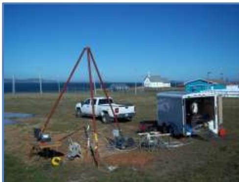
**Essais hydrauliques avec obturateurs pneumatiques**
