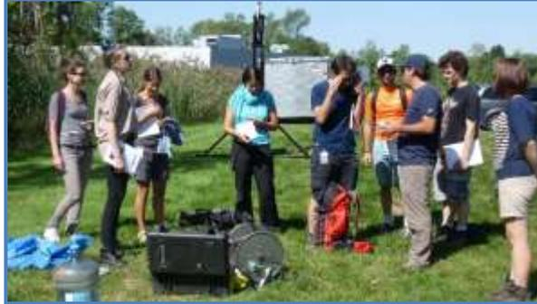
Mesure de la conductivité thermique sur des échantillons de sol (Norme ASTM D-5334)
