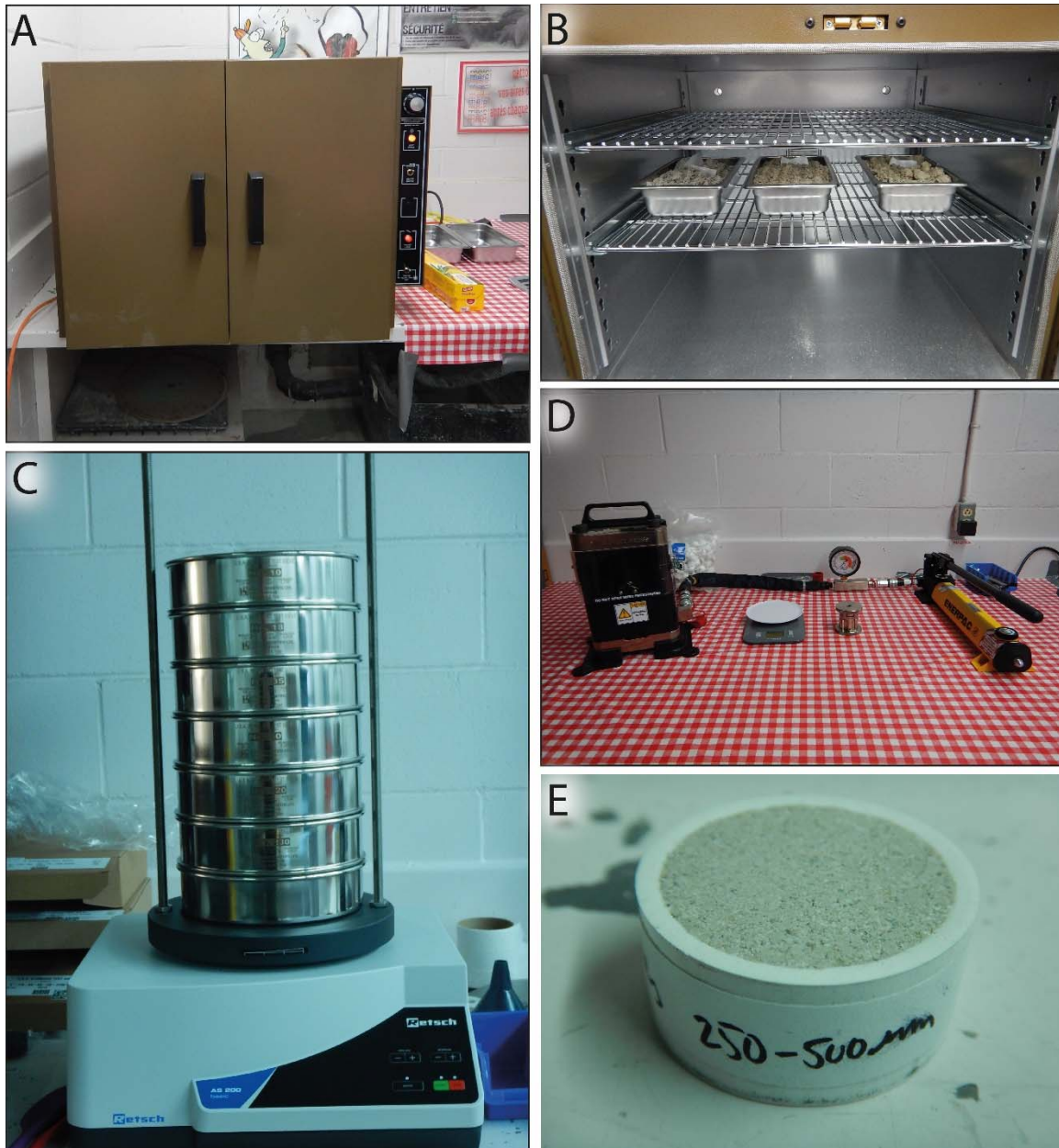
Figure 3.1. Illustration de certaines étapes de préparation des échantillons de till et de l'équipement requis. (a)-(b) Séchage des échantillons dans une étuve. (c) Tamisage mécanique avec des tamis de 2 mm, 1 mm, 0,5 mm, 0,25 mm, 0,125 mm, 0,063 mm et le récipient collecteur. (d) Presse hydraulique Reflex. (e) Exemple de pastille pressée.
